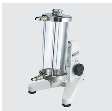
サンプルチューブ内にサンプルとボールを入れ、ボールの落下時間から粘度を算出します。
