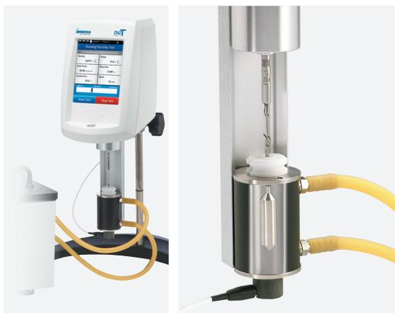
少量サンプルアダプターは、スピンドルとそれに対応するチャンバーで構成されており、2～16 mLのサンプル量で粘度を測定することが出来ます。
