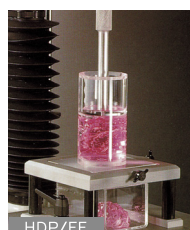
HDP/FE 押し出し治具
