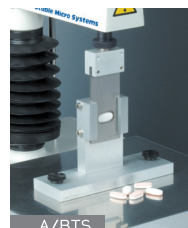
A/BTS 2層タブレットせん断治具
