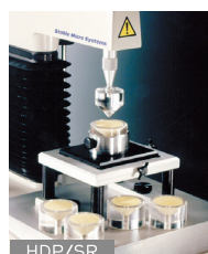
HDP/SR TTC塗りやすさ評価治具
