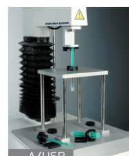
A/USR ユニバーサルシリンジ治具
