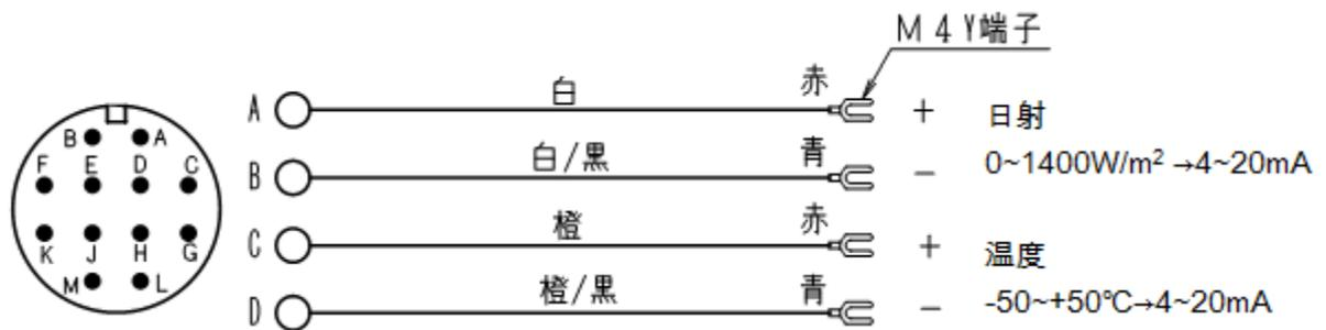
図 5-3. データロガーへの接続方法
