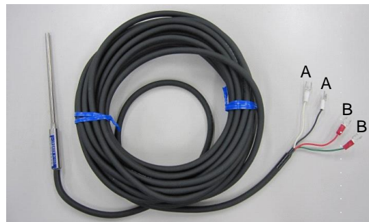
図 4-12. 気温測定素子と各導線
