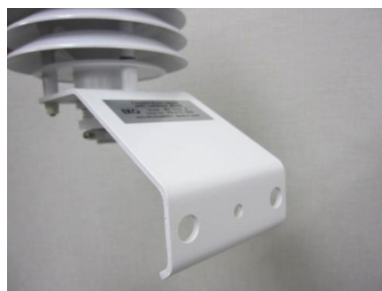
図 4-9. バンド類を取り外した状態
