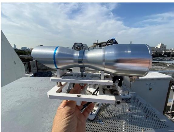
4) 外したローレットナットを再び取り付けます。MS-57SHがしっかりと固定されるように、きちんと締め付けてください。
