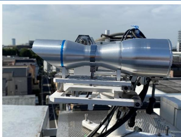
3) MS-57SHを取り付けプレート台に乗せます。取り付けネジは、プレートの中心にある固定穴に通してください。
