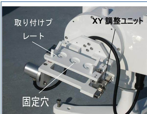
1) MS-57SHを設置する際は、取り付けプレートの中心にある固定穴を使用します。\*2穴式プレートの場合、3穴式プレートへの交換が必要となります。
