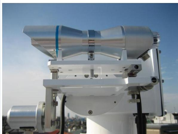
3) MS-57を取り付けプレート台に乗せます。取り付けネジは、プレートの中心にある固定穴に通してください。
