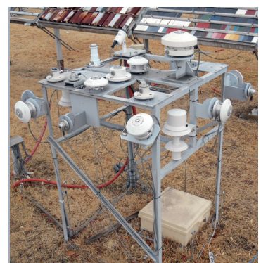
屋外暴露システム例
