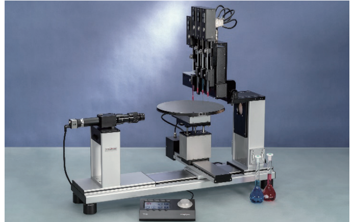
OCA50L (伸長タイプ) + ETT r・VAC 自動ターンテーブル + DDE/44 連ダイレクト滴下
