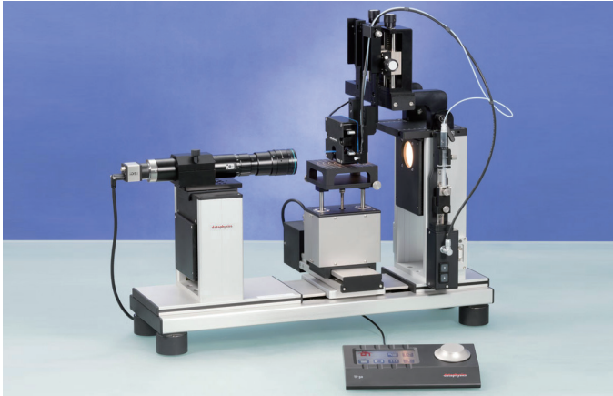
OCA200 (TP50 制御パネル付き) + PDDS ピコリットル滴下ユニット
