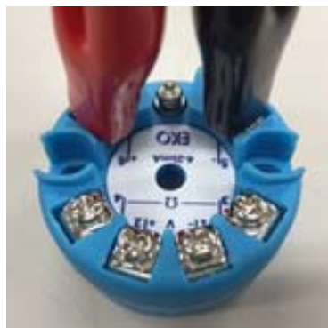
図 A-7.信号変換器と設定用ケーブルの接続
