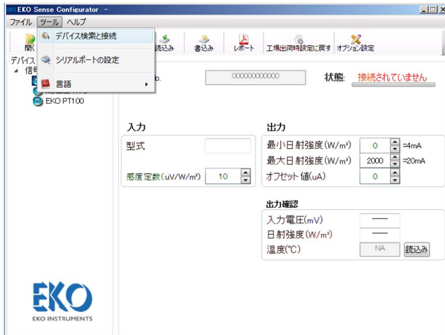
図 A-10. デバイス検索と接続ボタン表示画面
