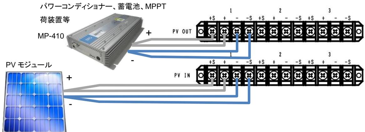
図 6-26. PV IN、PV OUT への接続方法
