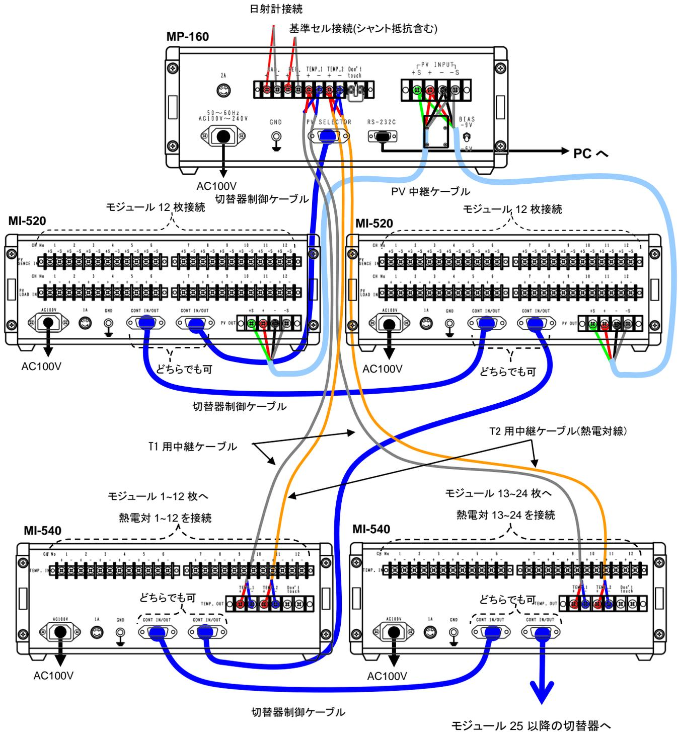
図 6-4. 接続図(モジュール 1 枚に対して温度 1 箇所の計測への対応方法)
