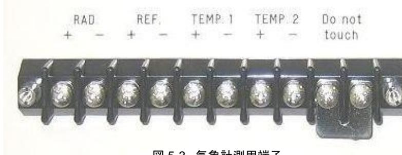
図 5-3. 気象計測用端子
