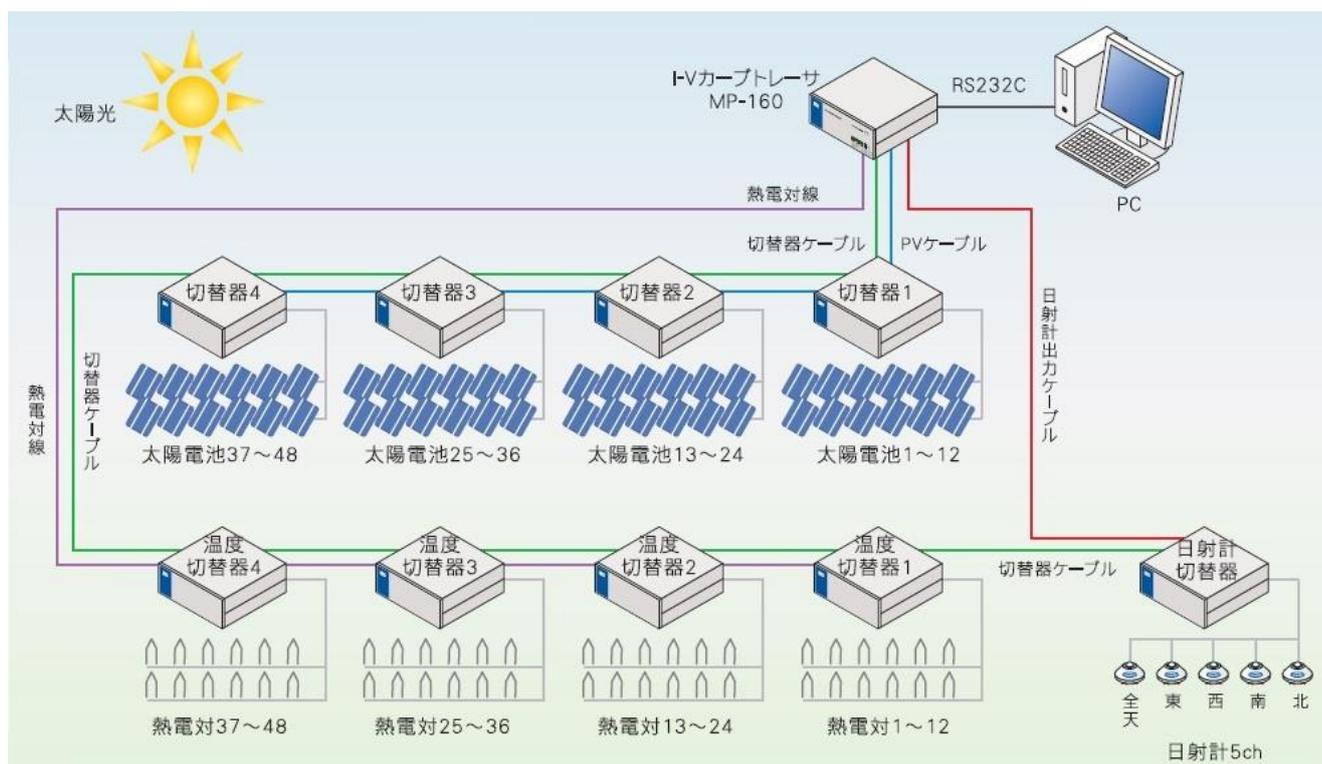
図 6-3. 切替器を使用した 1~48ch システム
