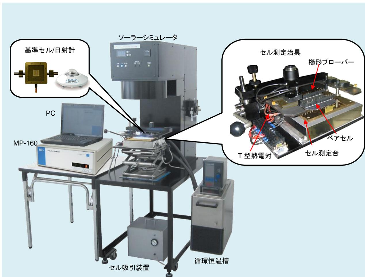
図 7-1. 太陽電池セル測定システム構成
