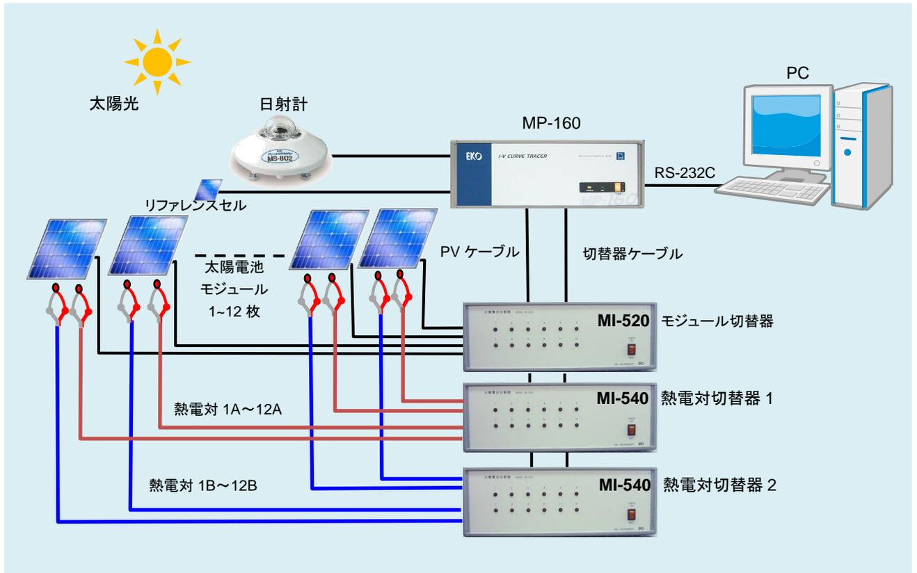
図 6-5. 切替器を使用した 1~12ch システム
