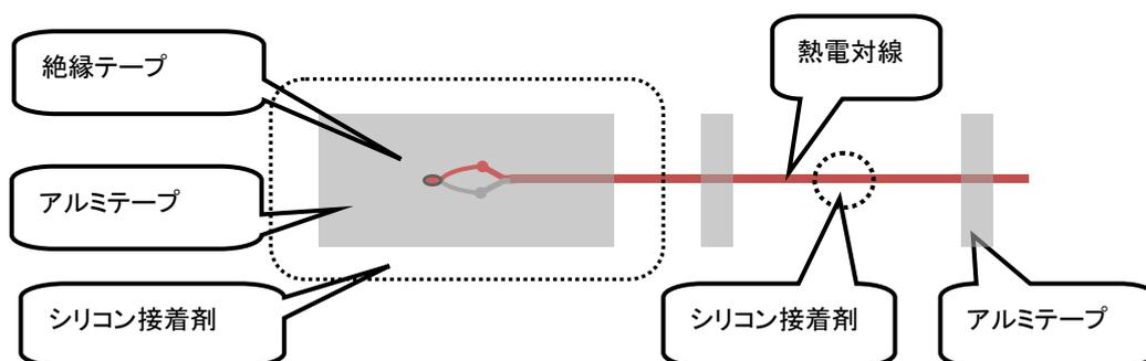
図 A-5. 熱電対の貼り付け方法
