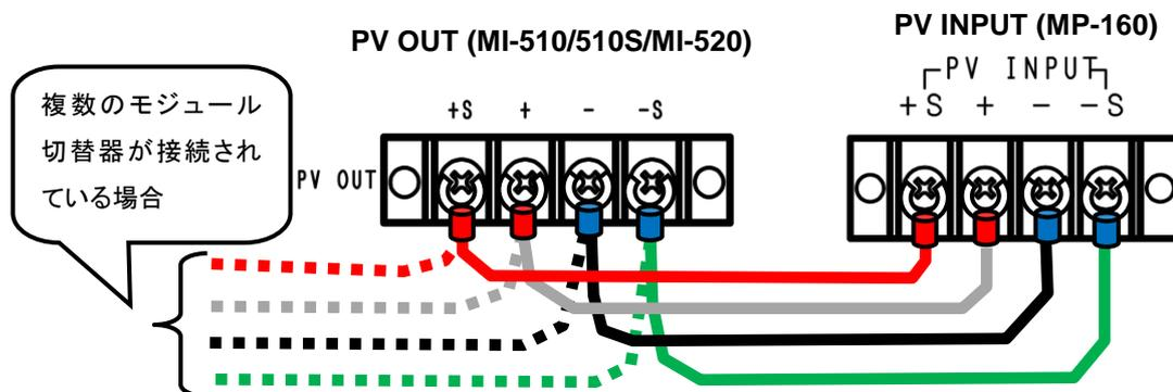
図 6-10. MI-510/510S/520 PV OUT & PV INPUT 接続方法
