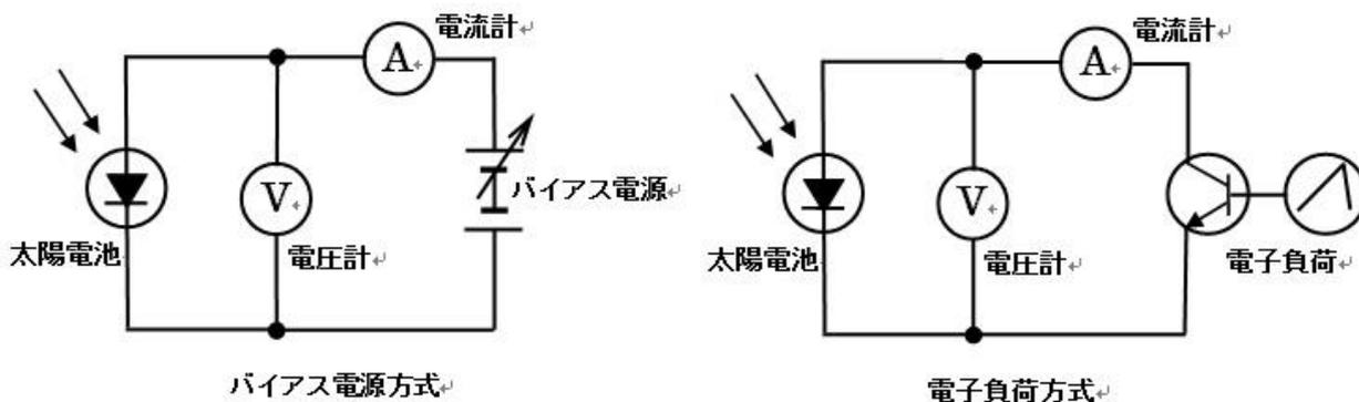
図 9-1. バイアス電源方式と電子負荷方式
