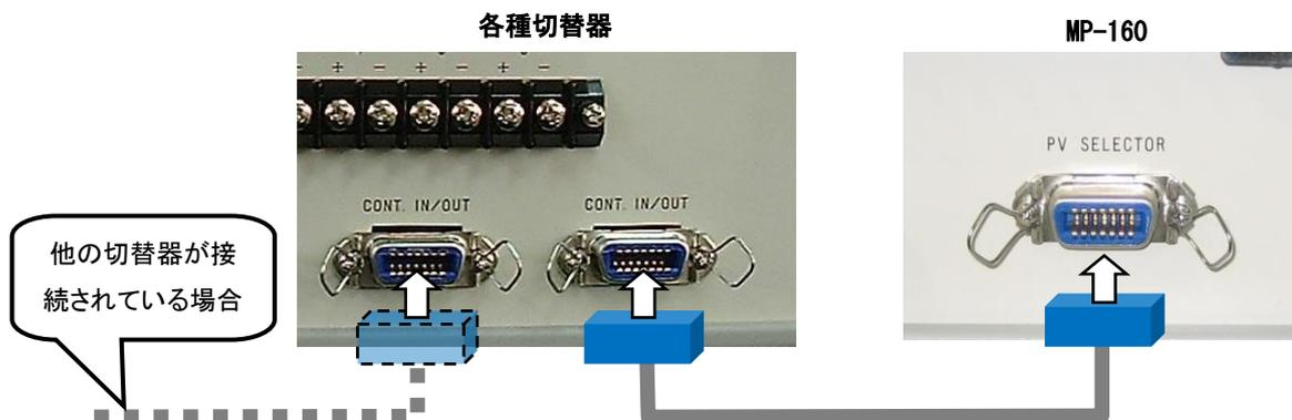
図 6-9. PV SELECTOR コネクタの接続方法
