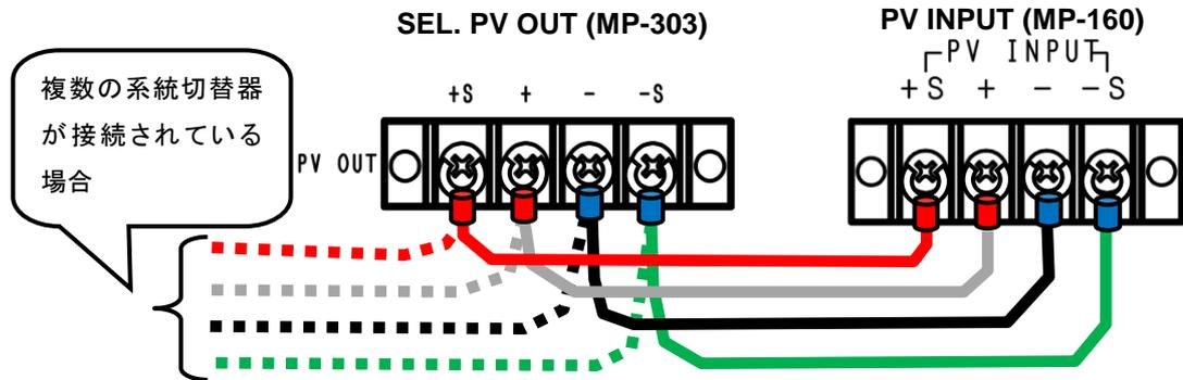
図 6-25. SEL. PV OUT & PV INPUT 接続方法
