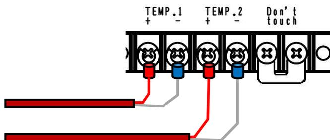
図7-3. TEMP.1 および TEMP.2 端子の接続
