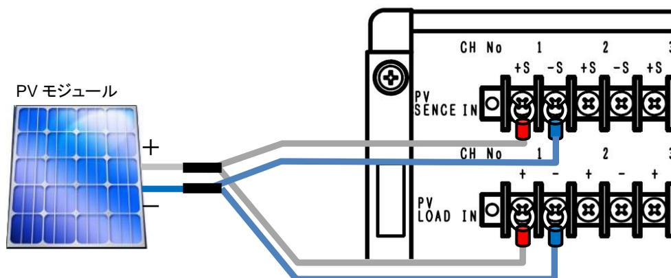
図 6-11. MI-510/510S/520 PV モジュールへの接続方法
