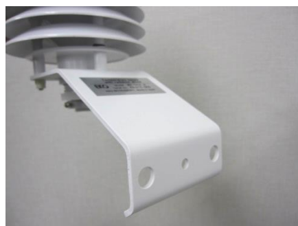
図 4-10. バンド類を取り外した状態
