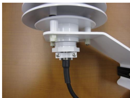
図 4-5. 気温測定素子の取り付け
