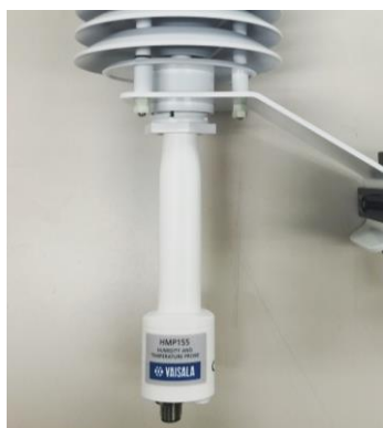
図 4-6. 温湿度計の取り付け
