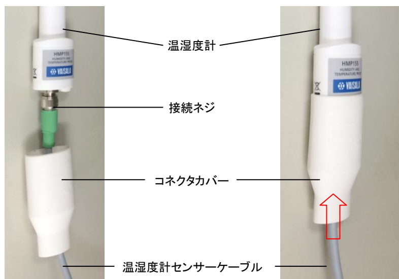
図 4-15. 温湿度計センサーケーブルの接続とコネクタカバーの装着
