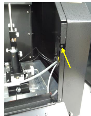
図 6-1-5. 扉開閉スイッチ
