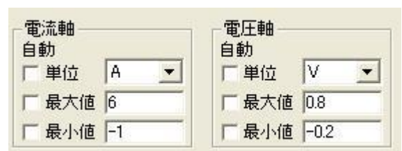
図 6-3-16. 電流、電圧軸スケール設定
