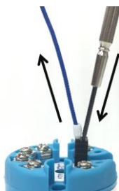
図 5-2. 通信ケーブル取り外し方
