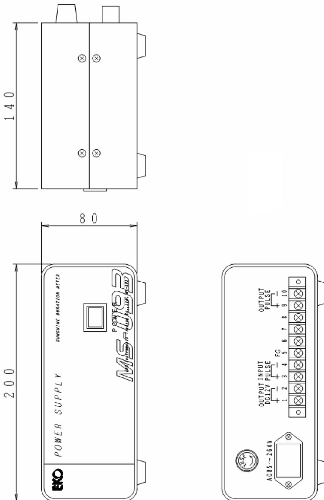
図 8-7. 電源ボックス寸法図
