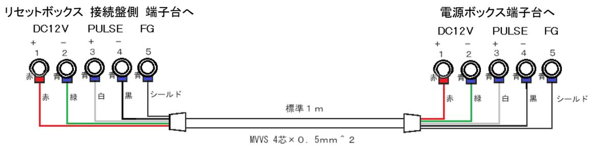
図 8-3. リセットボックス中継ケーブル
