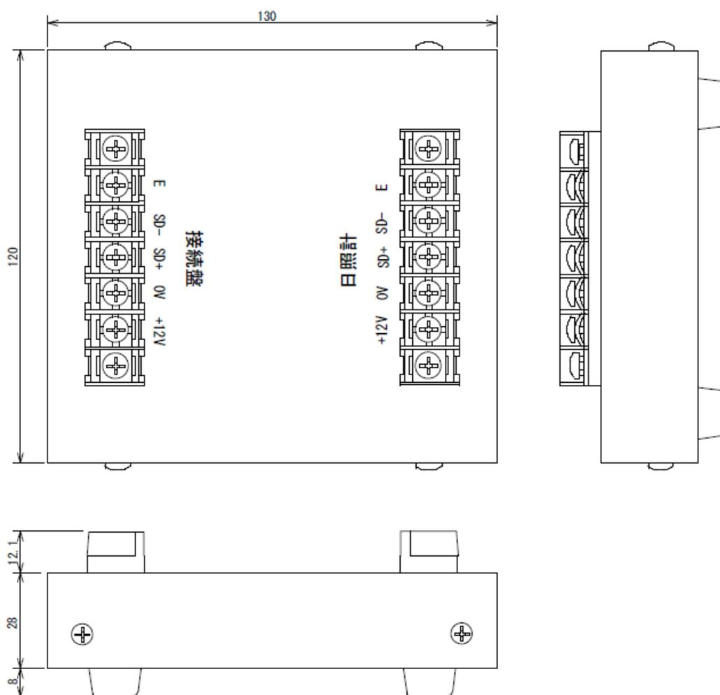
図 8-6. リセットボックス寸法図
