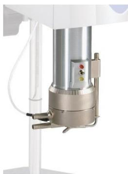
B型粘度計の発展形として開発されたコンプレート型粘度計では、コーンとカップ間のギャップが精密に設計され、せん断速度が規定されるので、絶対粘度値の測定が可能です。また取扱いサンプルも少量で済みます。電流感知式で正確なギャップを簡単に調整できます。
