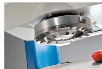
フローファンクションテスト用の羽根状カバー
