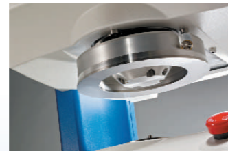
壁摩擦テスト用の板状カバー
