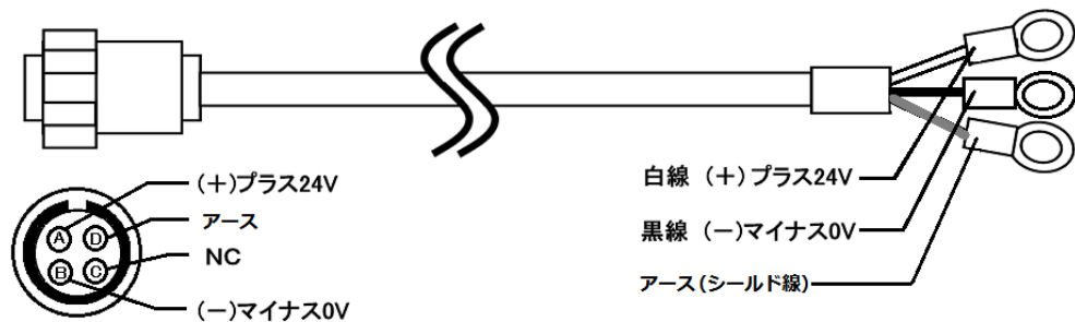
図 8-2. 各電源ケーブル図
