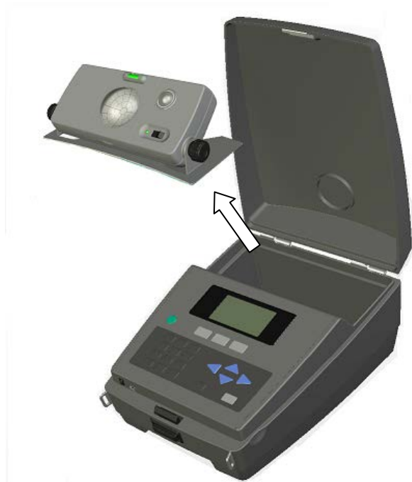
図 1 本体とセンサーユニットの分離
