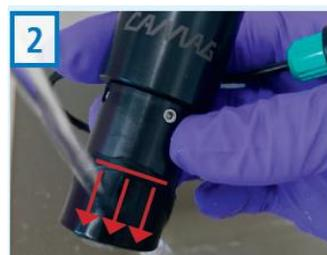
試薬を交換する場合は、ノズルの先端と試薬容器の内側を水やエタノール、洗浄液で洗い流します。
