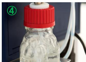
④ 容器内の残噴霧試薬を自動排気し、収集ボトルに集めます。
