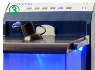
③ 試薬の粘度から4種類のヘッドを選択し、試薬を入れます。
