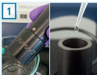
ノズルを空にし、各スプレーの前後に2 mLの洗浄液をスプレーします(レベル6)。
