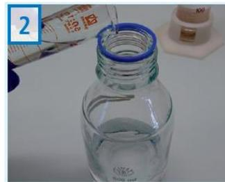
10 mLのNaCl水溶液を90 mLのエタノールで希釈します。約1 mmol/LのNaCl洗浄液が得られます。
