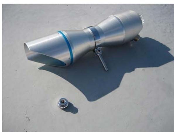
2) MS-57の取り付けネジからローレットナットを手で廻して外します(写真は取り外した状態)。
