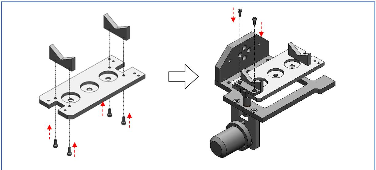
(5) (4)で外したVブロック2個を、(4)で外した3穴取り付けプレートの固定ネジ(M3x5mm 各2ヶ所)で取り付けてから、3穴式取り付けプレートをトラッカーアームに固定ネジ(M3x15mm 2ヶ所)で取り付けます。
