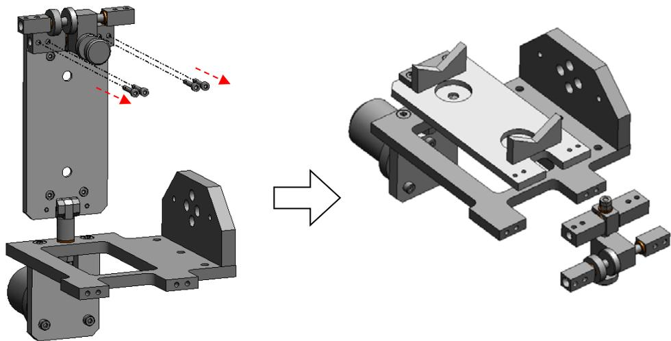
(3) 持ち上げた状態で、取り付けプレートから XY 調整ユニットの固定ネジ(M3x15mm 4ヶ所)を外し、XY 調整ユニットを外します。
