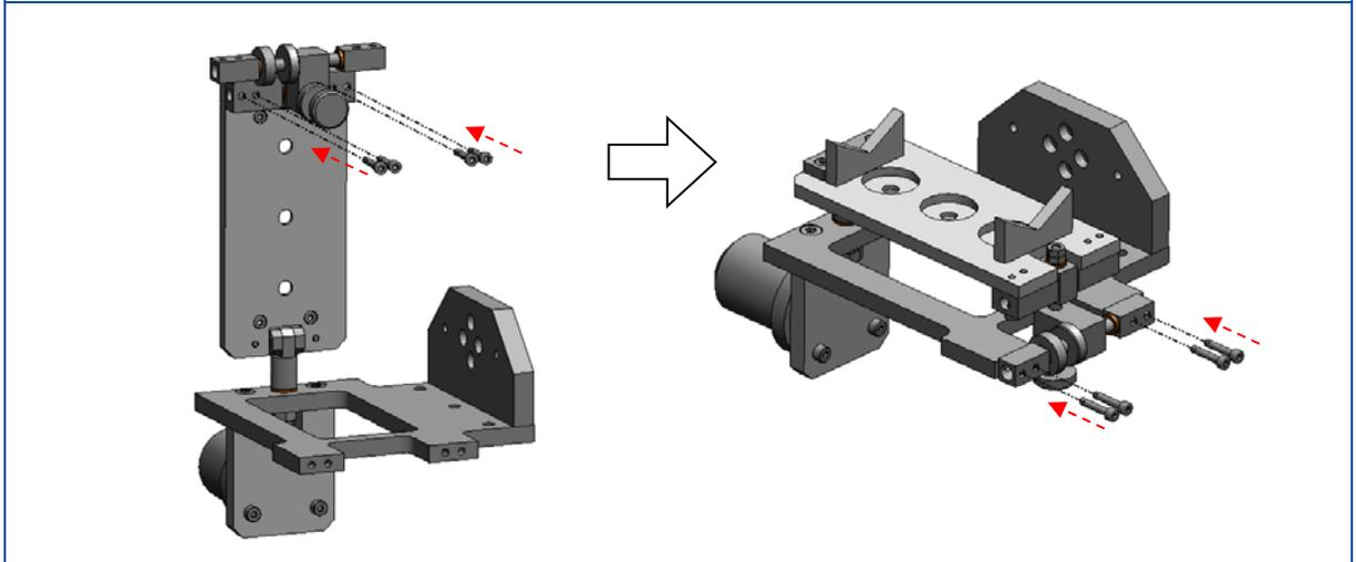
(6) 3穴取り付けプレートを持ち上げた状態で、(3)で外したXY調整ユニットを、XY調整ユニットの固定ネジ(M3x15mm 4ヶ所)で取り付けてから、トラッカーアームにXY調整ユニットの固定ネジ(M3x15mm 4ヶ所)で取り付けて完了です。最後に全てのネジの締め忘れが無いか確認してください。
