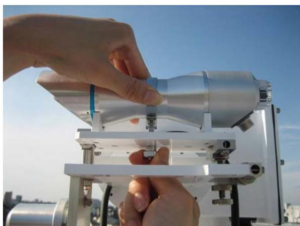
4) 外したローレットナットを再び取り付けます。MS-57がしっかりと固定されるように、きちんと締め付けてください。
