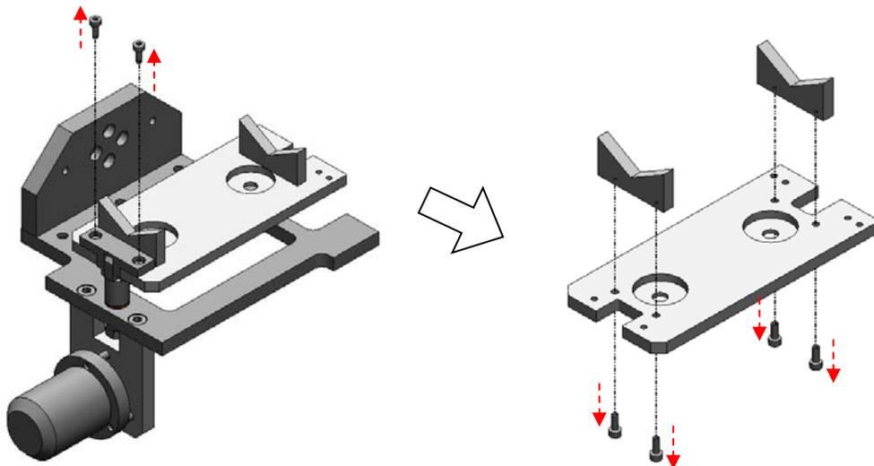
(4) トラッカーアームから取り付けプレートの固定ネジ(M3x15mm 2ヶ所)を外し、取り付けプレートを外します。取り付けプレートから、Vブロックの固定ネジ(M3x5mm 各2ヶ所)を外し、Vブロックを外します。
