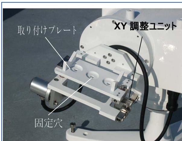
1) MS-57を設置する際は、取り付けプレートの中心にある固定穴を使用します。\*2穴式プレートの場合、3穴式プレートへの交換が必要となります([2. 取り付けプレート(オプション品)の交換]を参照)。
