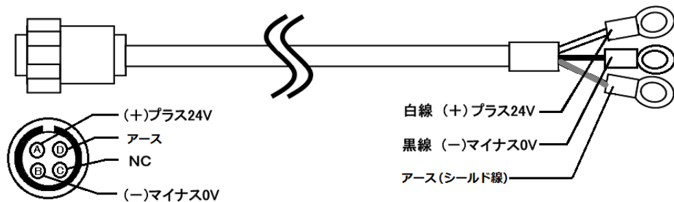
図 9-7. 各電源ケーブル図
